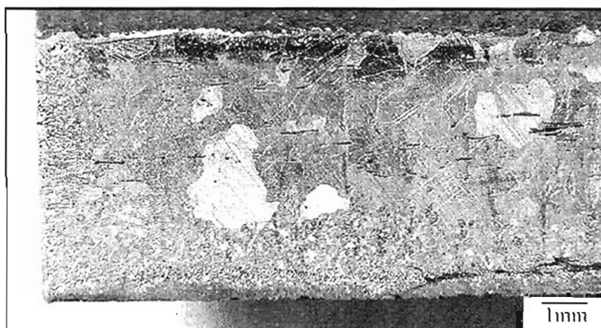
図 17 結晶粒粗大化部分（平行断面中央部試料）
