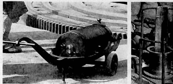
送弾車に載せた弾丸。弾丸の重量は217kgあるが送弾車は車軸上に重心を置いて1人で押す。装填管は踏板の右後端に立てて置く場所が決まっている。
