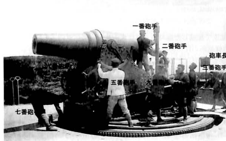
火砲の左側から見た各砲手の位置。左手奥に立てかけてある大型のスパナのようなものは射撃前に砲を2mm浮かせるため扛起機の圧螺を旋回する器具。
