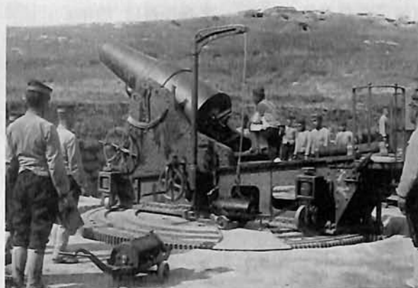
旅順要塞を砲撃する28榴。左端の八番砲手が右手に持つ雑巾は弾丸の表面に付着した土砂を拭き取るためのもの。送弾車は旧型の1軸2輪式。
