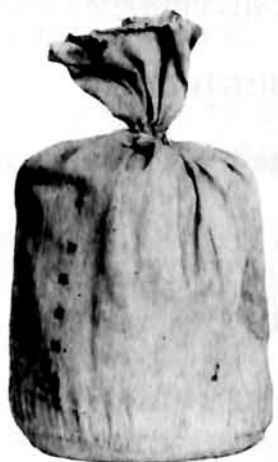
28榴の薬囊。装薬管に入れて運搬し装填管上に載せて動底を押し込むことにより薬室に装填する。
