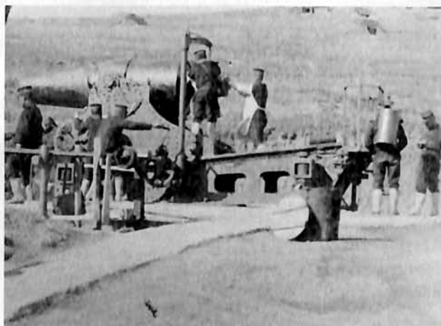
二番砲手が弾提鏈提把を握り、弾丸を装填管上に載せようとするところ。手前に蓋をとった水桶がある。
