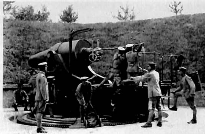
十番砲手は装薬管を背負い後方で待機。四番砲手が下りるとすぐ踏板上に装薬管を下ろす。
