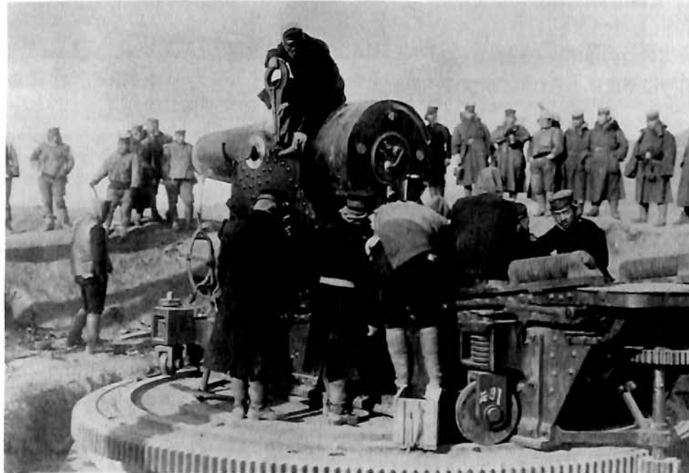
28糎の組立。砲身に跨った兵が砲耳に指針を装着しようとしている。閉鎖機、揚弾機、鉄欄などはまだ組み立てられていない。
