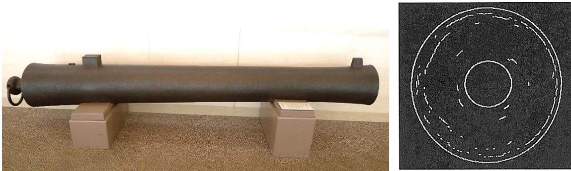
図 1 芝辻砲(靖国神社遊就蔵)、全長 3.13 メートル 図 2 芝辻砲の超音波断層写真 2)
